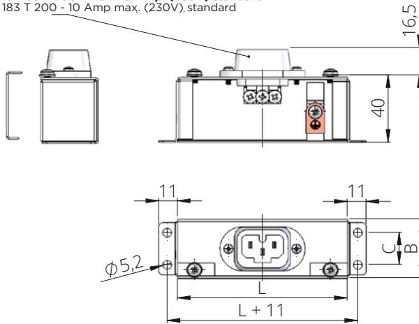
Gehäuse ohne Klemmschienen / Casing without terminal strip
