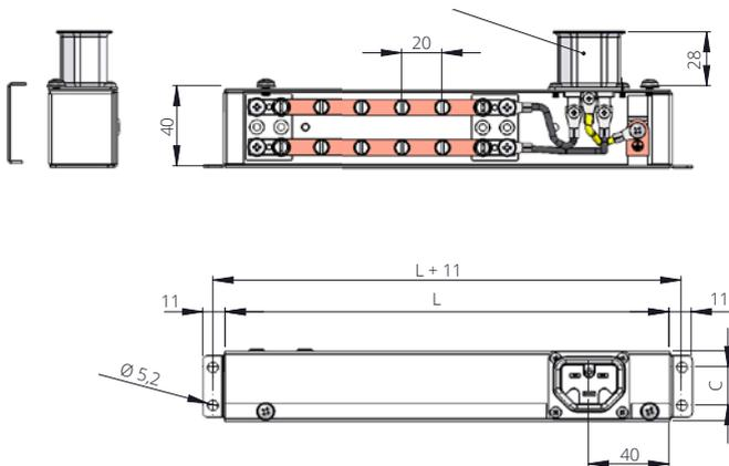
Gehäuse mit Klemmschienen, Option: mit Stecker 444.1, ab Breite 50 mm Gehäusehöhe
